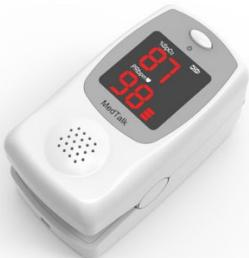
Dieses Gerät misst die Pulsfrequenz und die Sauerstoffsättigung in Sekundenschnelle. Der Messbereich der Sauerstoffsättigung liegt zwischen SpO<sub>2</sub>: 70% - 100%, beim Puls zwischen 30 - 250 Schläge/Min. Das kleine mitnehmbare Gerät hat die Maße 61 x 34 x 35mm, ist handlich und hat eine sehr einfache Bedienung. Es schaltet sich bei Nichtgebrauch selbstständig ab. Betrieben wird es mit 3 AAA Batterien, die im Lieferumfang bereits dabei sind. Preis dieses neuen Gerätes: Euro 50,--
